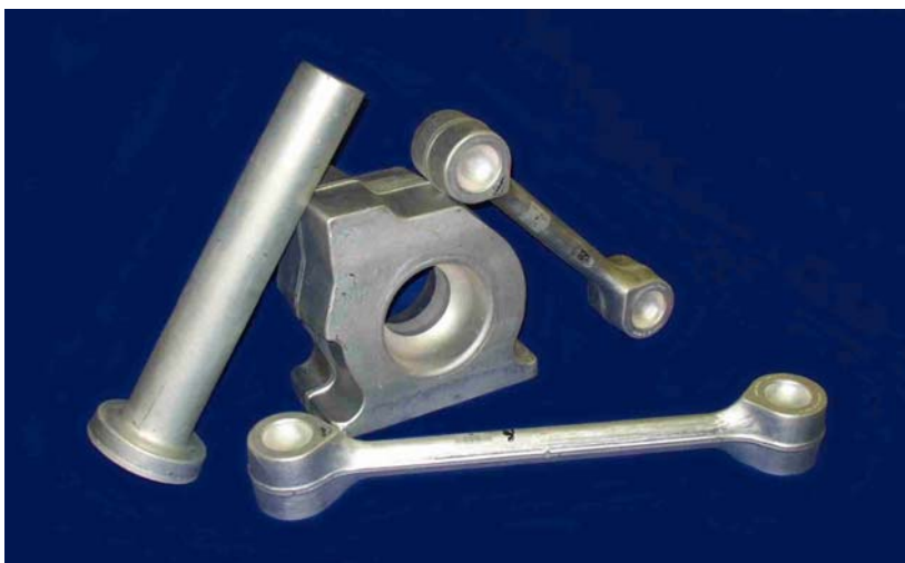
Bild 15: Geschmiedete Rohlinge für Lenker, Welle und Lagerbock des Hochgeschwindigkeitszuges Talgo 350, Legierung: AlMgSi1 (Bild: Otto Fuchs KG, Meinerzhagen, Deutschland)
