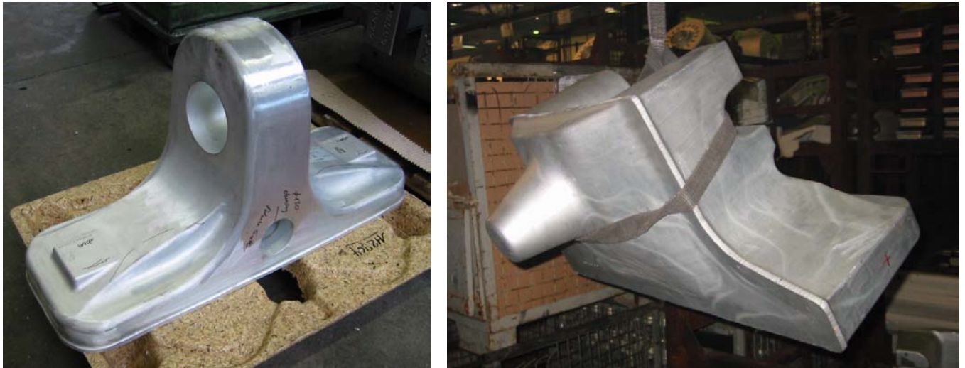
Bild 8: Gesenkgeschmiedete Rohlinge der Gelenkaufnahme (links) und des Gelenkträgers (rechts)
