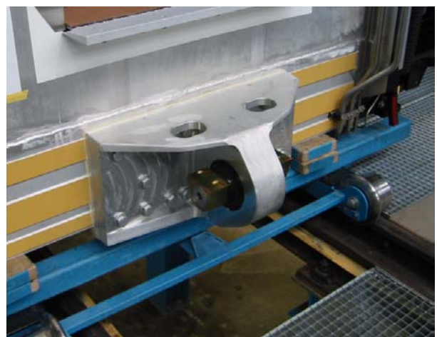
Bild 13: Gelenkkonsolen des Gelenktriebwagens von Stadler Rail AG. Geschmiedeter Rohling und eingebautes, bearbeitetes Bauteil. (Rohteil: 146.4 kg, Bearbeitungsgrad 29%)
